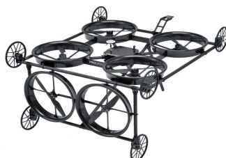
天井面・垂直壁面両方の検査が可能な 自走式張り付き型ドローン「PD6-CI-L」
