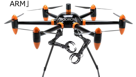
世界初、2本のロボットアームをもつ 直接作業型大型ドローン「PD6B-AW-ARM」
