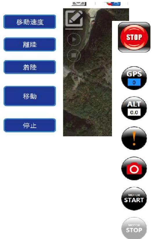
プロポをつかわずに、タブレット・パソコン・ジョイスティックで、始動から機体の移動、自動帰還、着陸停止を操縦
